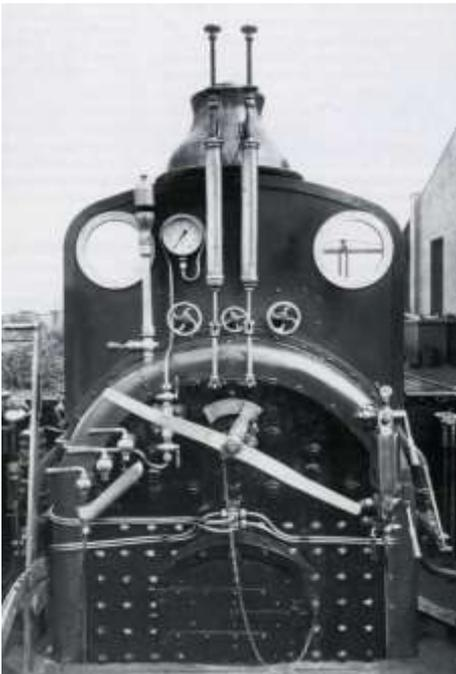
Cabina de conducción de la réplica de la MATARÓ, año 1848.La disposición de los mandos es similar, pero con las dos válvulas en el domo principal, aparte del tubo de nivel va equipada con los tres grifos de comprobación reglamentarios en la Renfe. Los tres volantes frontales corresponden a la alimentación de vapor a los inyectores y al ventilador de la caja de humos; inexistentes en las máquinas originales.
