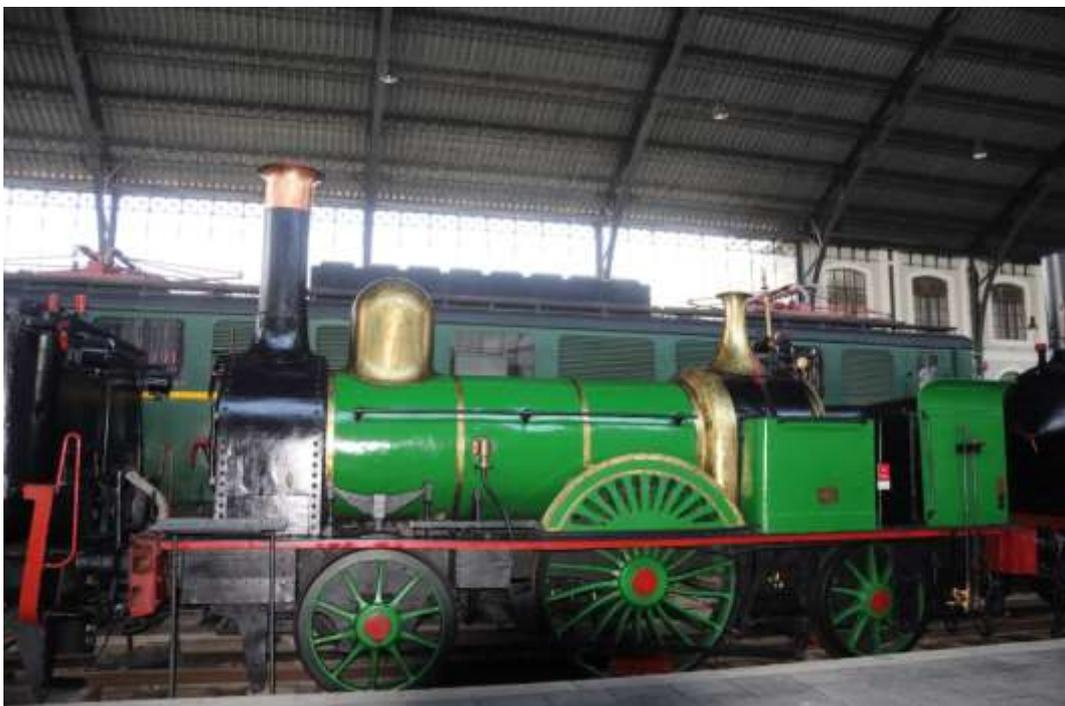
Imagen actual de la 1-1-1 cuyo origen atribuimos al Ferrocarril de Barcelona a Granollers del año 1853. Se aprecia claramente la deformación centrífuga de los radios de la rueda motriz, provocada por algún percance cuando trabajaba como máquina fija.
