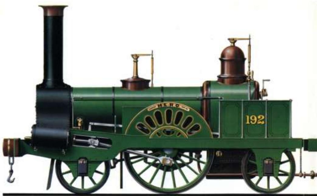
Diseño original de una locomotora Allan-Crewe de una sola rueda motriz de gran diámetro, equipada con una válvula de seguridad en cada domo, similar a las adquiridas para el Barcelona-Mataró
